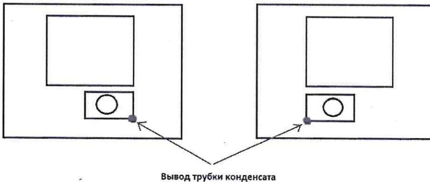
**Допустимая схема установки внешнего блока сплит-системы (компрессорно-конденсаторного агрегата с прокладкой магистрали трубопровода на фасаде дома.**
